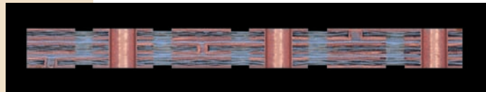
6層板スルーホールクロスセクション (BVH, IVH) 6-layers through-hole cross-section (BVH, IVH)
