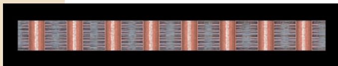
10層板スルーホールクロスセクション (貫通スルーホール) 10-layers through-hole cross-section (through-hole)
